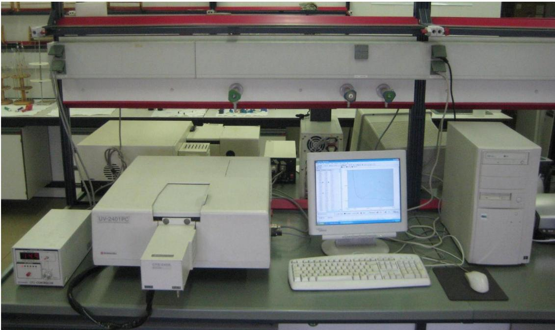
Figura 3.5. Espectrofotómetro Shimadzu UV-2401-PC de doble haz.
