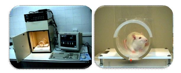
**Figura 6**: Sistema SR-LAB donde se han llevado a cabo las mediciones del RAS y de la IEP.En la imagen de la derecha se puede observar en detalle, el cilindro en donde se coloca el animal que lleva una plataforma con un acelerómetro (la flecha) susceptible de detectar todos los movimientos del animal.
