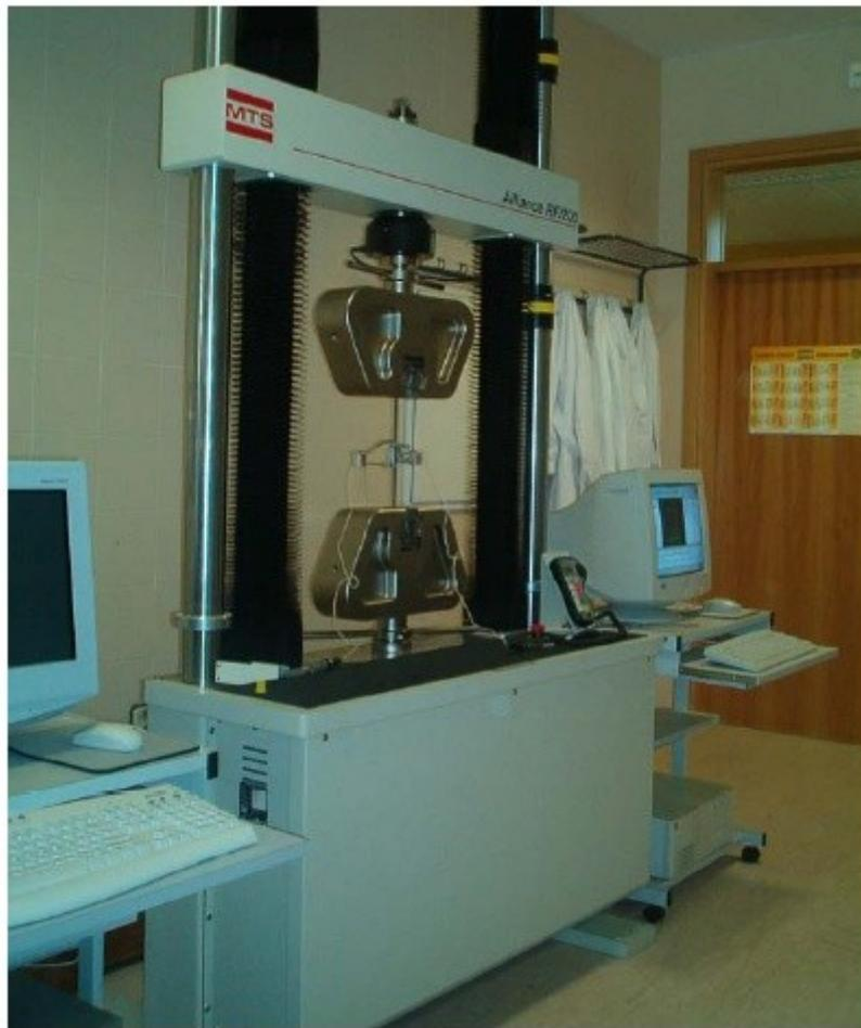
Fig. 2.9. Máquina universal de ensayos MTS 200 kN.
