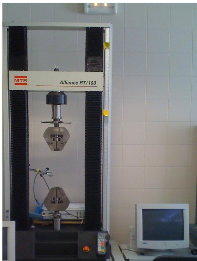
Fig. 3.18. Máquina de ensayo MTS RF100 utilizada en los ensayos para la generación de estados tensodeformacionales en probetas entalladas.
