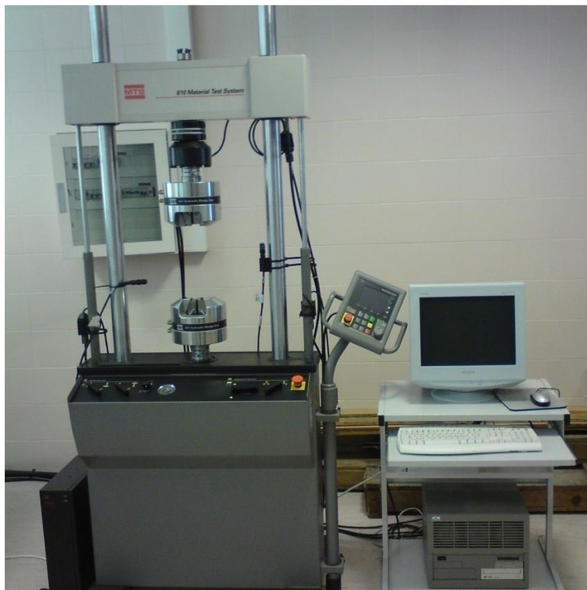
Fig. 2.23. Máquina de ensayo servo–hidráulica MTS utilizada en los ensayos para determinar el EB de los aceros estudiados.
