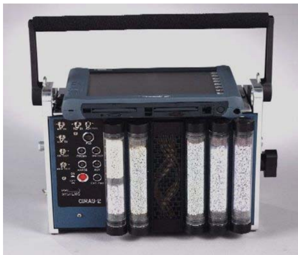
Figura 3.3.1 Imagen del analizador de gases en el infrarrojo (IRGA) portátil empleado en la presente investigación para realizar las medidas in vivo de la velocidad de asimilación fotosintética (A), velocidad de transpiración (E) y de la conductancia estomática ( g_s ).
