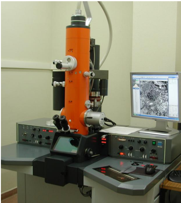
Figura- MM-1.- Microscopio Electrónico de Transmisión Zeiss-900 del Servicio de Microscopía electrónica de la USAL.
