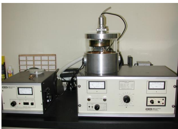
Figura MM-2.- Aparatos de secado (“punto crítico”) y de metalización de la casa Bio-Rad.
