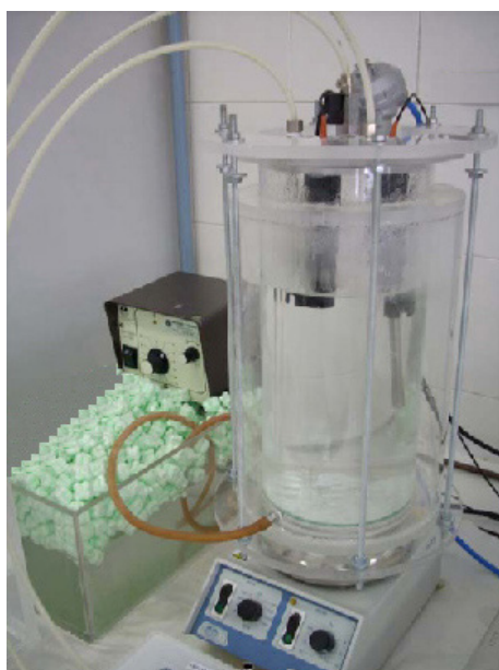
Figura 5.159. Sistema de control de temperatura
