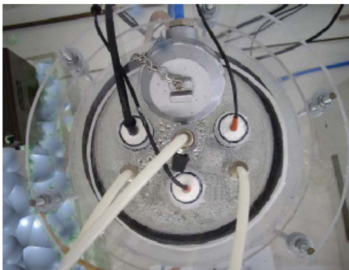
Figura 5.158. Tapa del reactor aerobio
