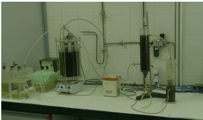
Figura 5.162. Instalación anaerobia en fase de producción de biomasa
