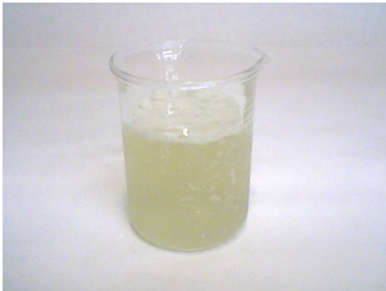
Figura 5.5. Aspecto del lixiviado de la balsa de comunes del CTR de Burgos.
