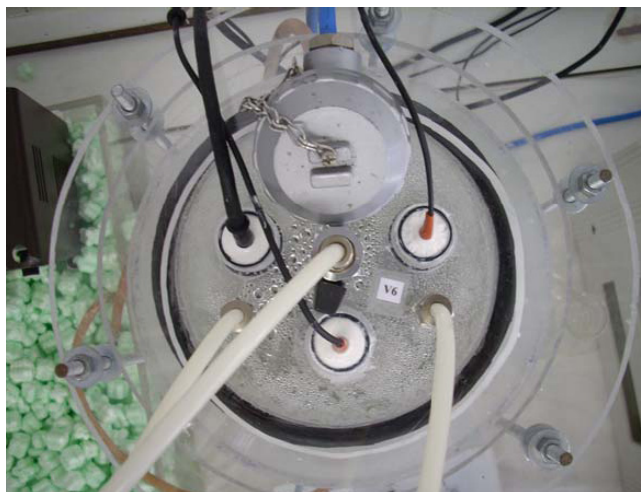
Figura 5.140. Montaje de la tapa del digestor.
