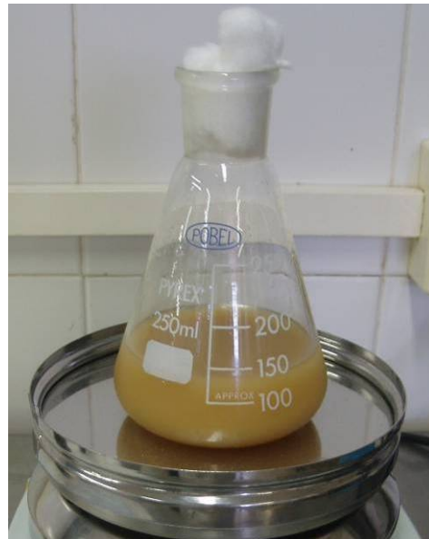
Figura 5.137. Aspecto de líquido resultante del ensayo de biodegradabilidad.
