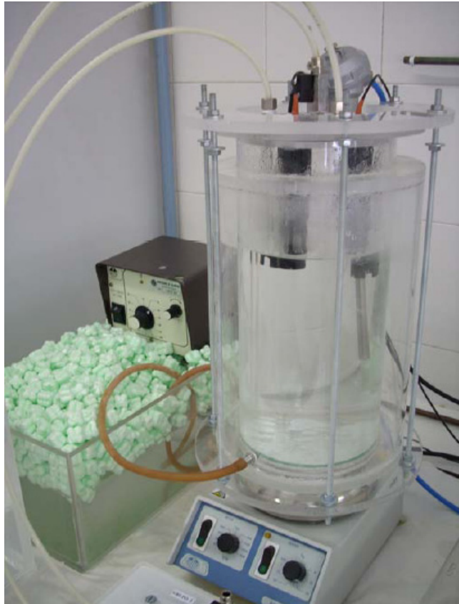
Figura 5.141. Digestor y sistema de control de temperatura.
