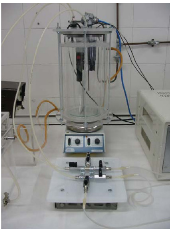
Figura 5.139. Montaje y cierre del digestor anaerobio
