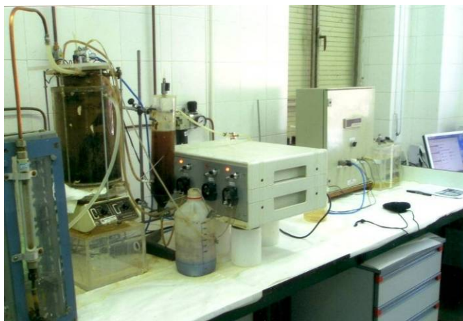
Figura 5.256. Instalación aerobia en fase de producción de biomasa
