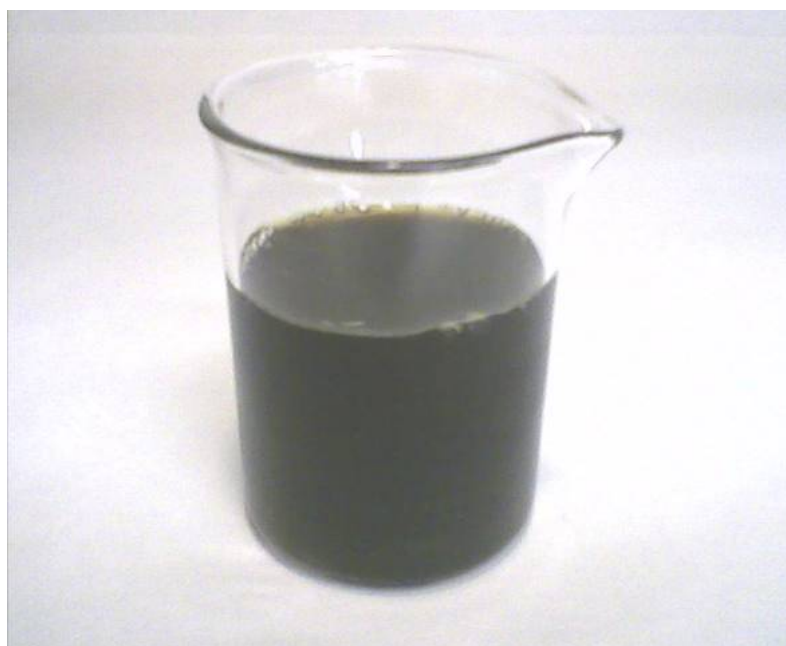
Figura 5.3. Aspecto del lixiviado de la balsa de comunes del CTR de Zamora.
