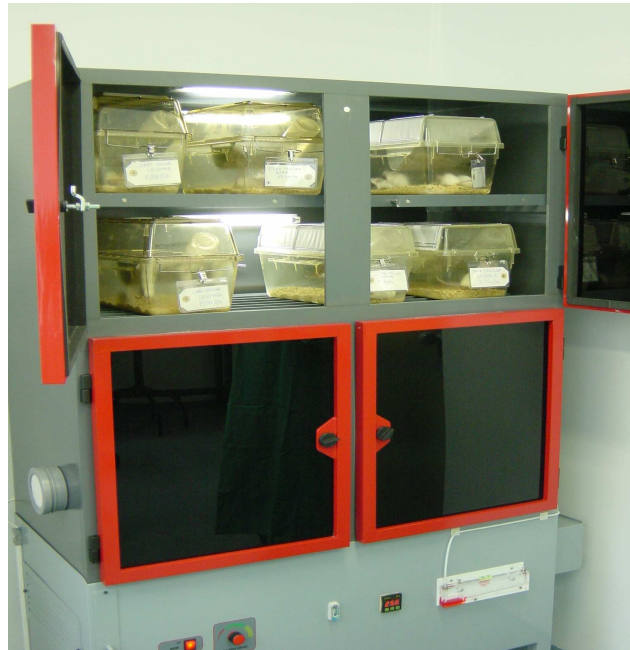
Foto 1. Jaulas esterilizadas para el mantenimiento de los ratones
