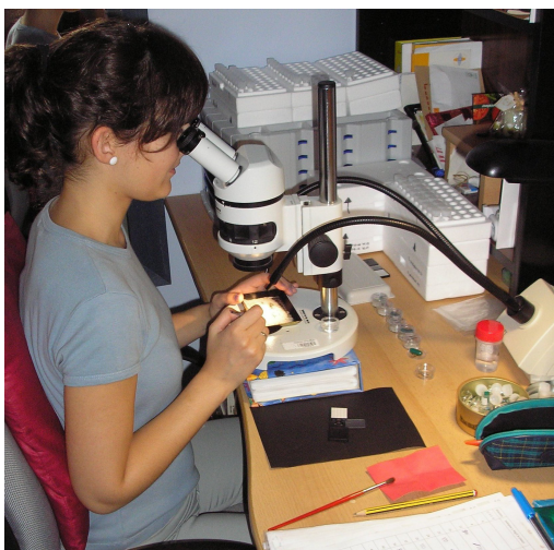
Fig. 2.4. Microscopio estereoscópico o lupa binocular con la que se realizaron los recuentos de los foraminíferos e IRD, así como el picking de foraminíferos.
