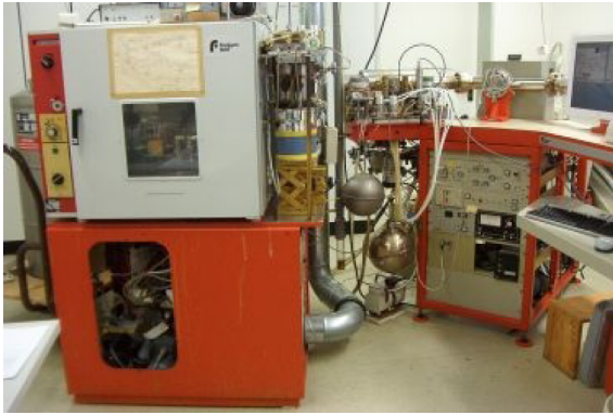
Fig. 2.9. Espectrómetro de masas Finnigan MAT 251 de la Universidad de Kiel utilizado para los análisis isotópicos de oxígeno y carbono en foraminíferos bentónicos. La fotografía se ha tomado de la página web del laboratorio Leibniz para datación radiométrica y análisis isotópicos de la Universidad de Kiel, Alemania ( http://www.sct.ub.es/w3/wesp/hom/hom_0000.htm ).
