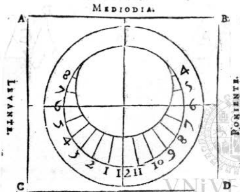
Figura de vn reloj Equinocial, traçado en vn redondo excavado por la parte de dentro, cuya superficie mixta representa la Equinocial.
