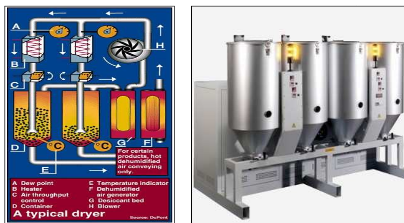
FIGURA 229: EQUIPO ACONDICIONADO MATERIALES POLIMÉRICOS TERMOPLÁSTICOS
