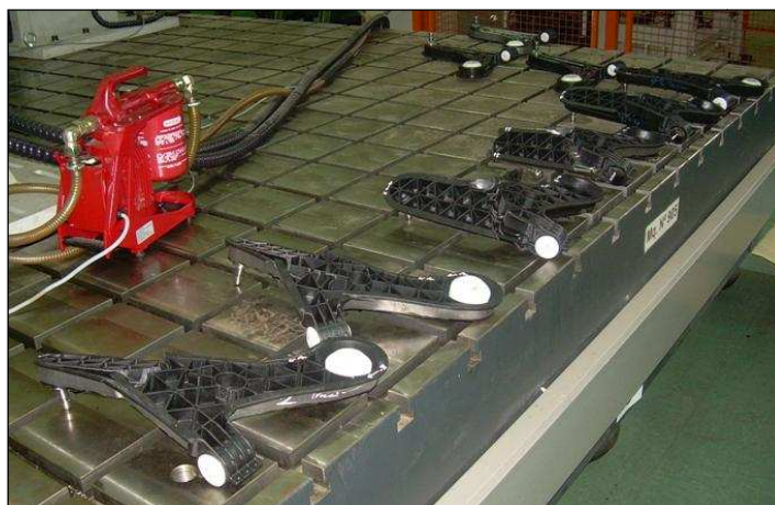
FIGURA 351: BRAZOS DE SUSPENSIÓN HÍBRIDOS ENSAYADOS
