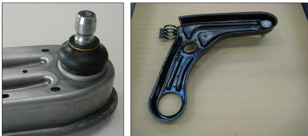
FIGURA 341: PROTOTIPOS BRAZO DE SUSPENSIÓN HÍBRIDO PRE-MONTADO PARA INYECCIÓN
