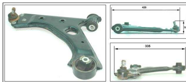
FIGURA 265: BRAZO DE SUSPENSIÓN COCHE PILOTO: FIAT GRANDE PUNTO (AÑO 2006)
