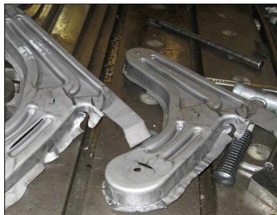
FIGURA 339: RESULTADOS CONFORMADO CHAPA DE ACERO DEL BRAZO DE SUSPENSIÓN HÍBRIDO – DP 600 –
