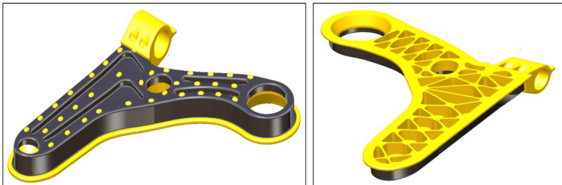
FIGURA 311: MODELO CAD: BRAZO DE SUSPENSIÓN HÍBRIDO FIAT GRANDE PUNTO VERSIÓN 1
