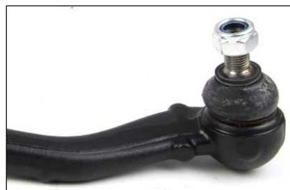
FIGURA 121: CONCEPTO RÓTULA – CARCASA INTEGRADA
