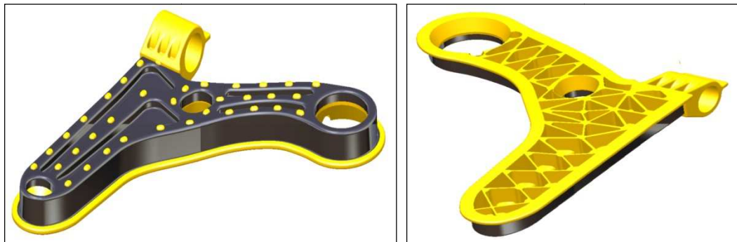
FIGURA 316: MODELO CAD: BRAZO DE SUSPENSIÓN HÍBRIDO FIAT GRANDE PUNTO VERSIÓN 2
