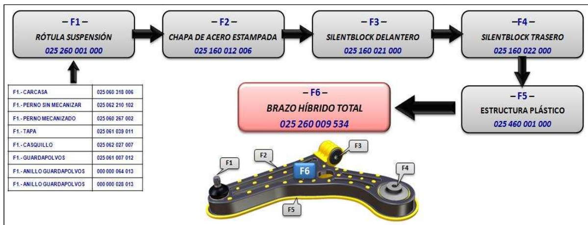
FIGURA 296: LISTA DE COMPONENTES DEL BRAZO DE SUSPENSIÓN HÍBRIDO – FIAT GRANDE PUNTO (AÑO 2006) –
