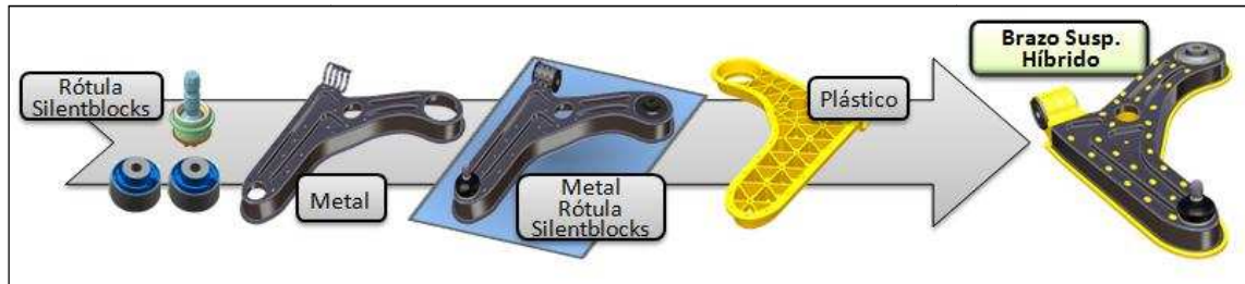
FIGURA 353: FABRICACIÓN DEL BRAZO DE SUSPENSIÓN HÍBRIDO EN SERIES: OPCIÓN 2
