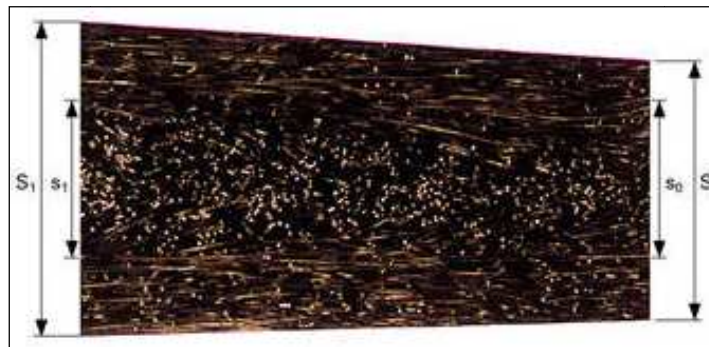
FIGURA 232: EFECTO DE VARIACIÓN DEL ESPESOR DE LOS NERVIOS EN LA ORIENTACIÓN DE LAS FIBRAS
