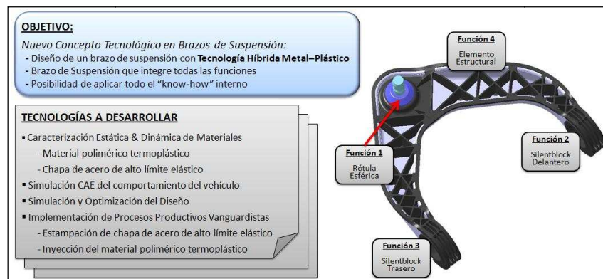
FIGURA 151: INNOVACIÓN Y NOVEDAD: BRAZO DE SUSPENSIÓN HÍBRIDO METAL - PLÁSTICO
