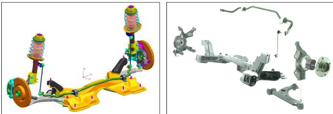
FIGURA 263: EJE DELANTERO COCHE PILOTO: FIAT GRANDE PUNTO (AÑO 2006)
