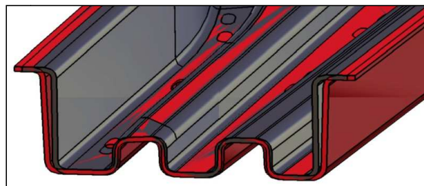
FIGURA 331: FENÓMENO DE RECUPERACIÓN ELÁSTICA DEL MATERIAL (GRIS HC420LA – ROJO DP600)
