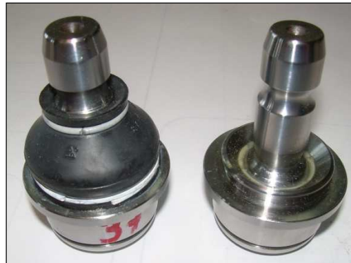
FIGURA 340: PROTOTIPOS DE LA RÓTULA DEL BRAZO DE SUSPENSIÓN HÍBRIDO
