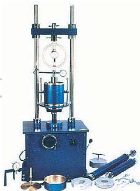
Aparato del ensayo CBR
