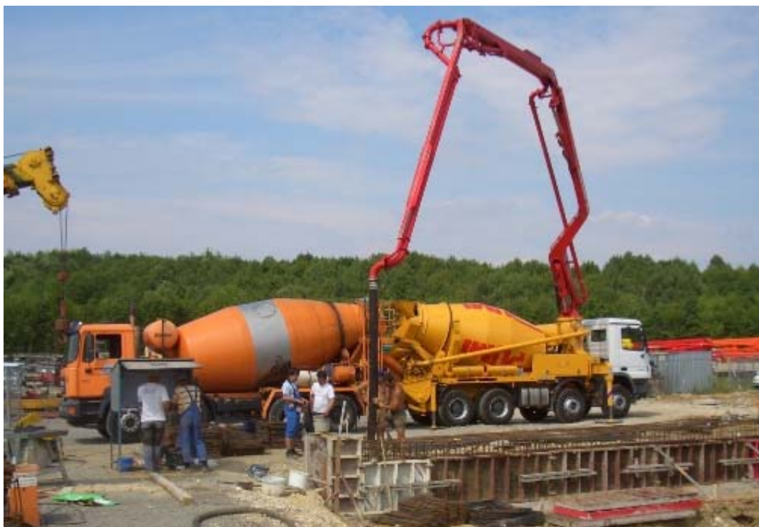
Camión bomba de hormigón
