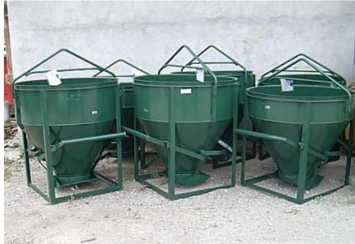
Cubilote de vertido de hormigón
